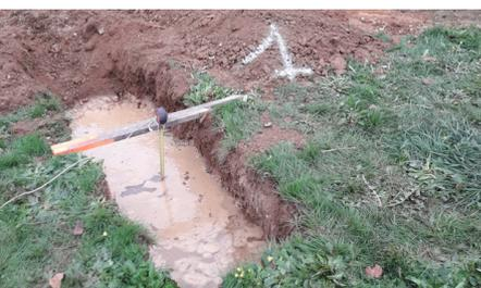
Le dimensionnement des ouvrages de gestion des eaux pluviales sera basé sur des mesures de perméabilité de type MATSUO (de préférence) réalisées à la profondeur des ouvrages projetés (/\ creusement des fossés au godet à dents).
